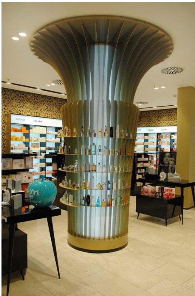
Säule mit Hintergrundbeleuchtung aus LED-Slimline Panels
